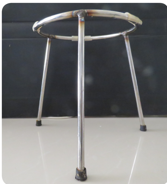
شکل ۷- سه پایه استیل برای استقرار و جابه‌جا کردن بیوراکتور
