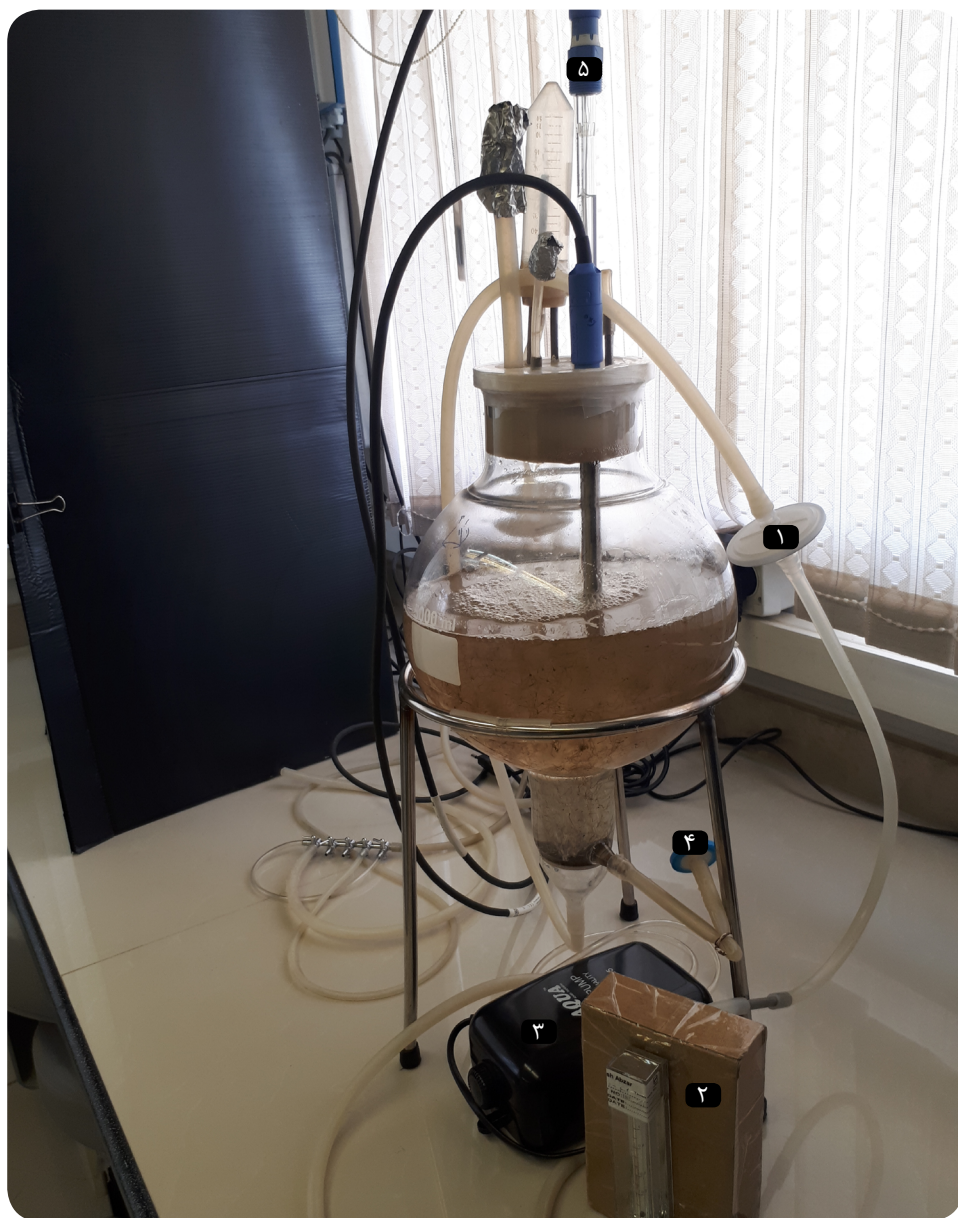
شکل ۸- روش اتصال تجهیزات جانبی بیوراکتور: ۱- نحوه صحیح استقرار فیلتر هوای ورودی، ۲- روتا متر، ۳- کمپرسور هوا، ۴- مسیر نمونه برداری و تخلیه، ۵- رطوبت گیر جریان هوای خروجی
